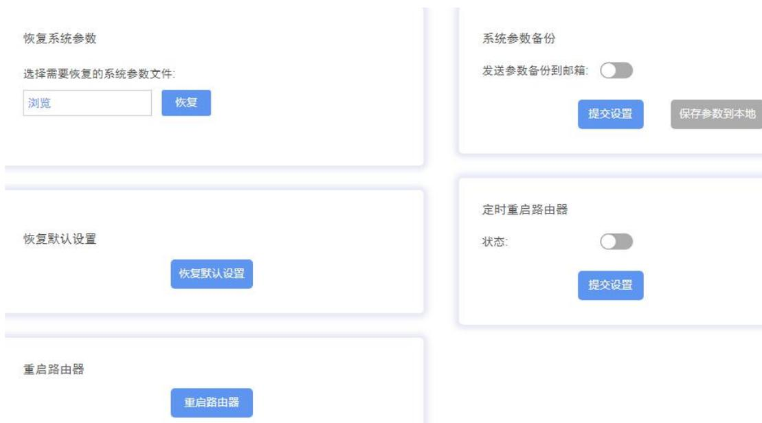
**恢复系统参数:** 将预先保存的系统配置文件导入到路由器（配置文件为 .cfg 格式的）。请不要将其他路由器的配置文件导入到本路由器，否则将导致路由器不能工作；
