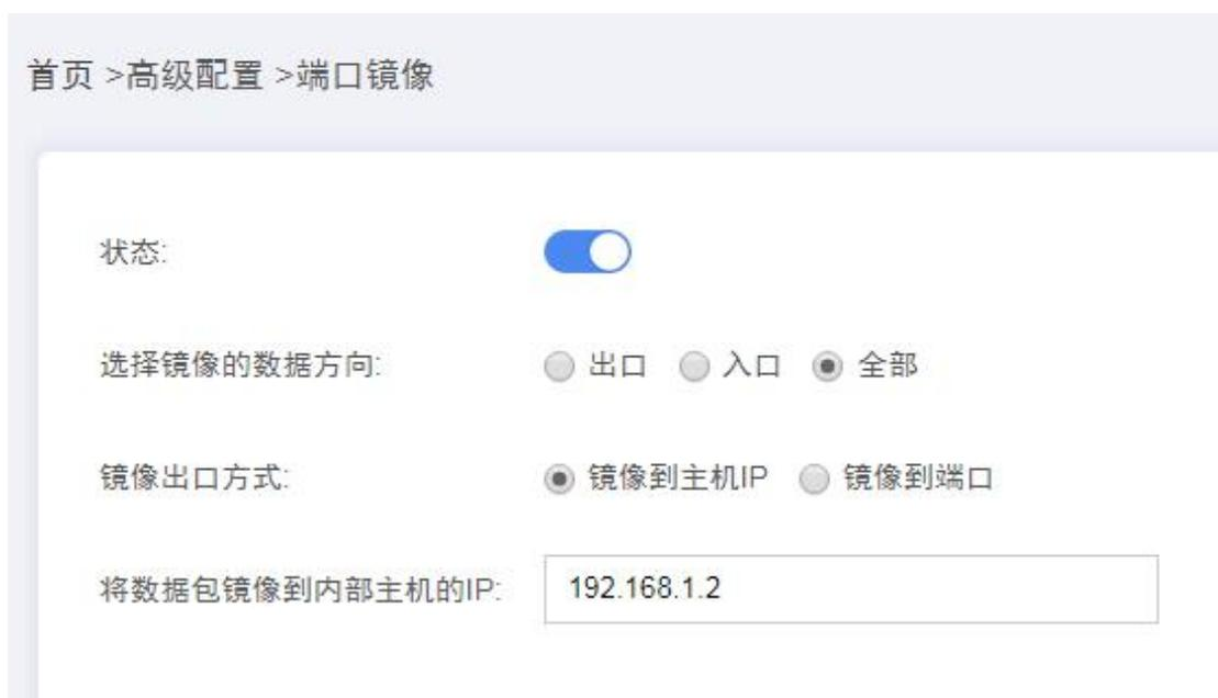
如上图所示，开启了 WAN1 口作为镜像口，那么就需要将 WAN1 口设置为局域网模式，并填入一个跟 LAN 口不冲突的虚拟子网。需要镜像的机器单独接到 WAN1 口，并设置 WAN1 口的 IP 作为镜像机器的网关地址，保证镜像机器 IP 与 WAN1 口处于同一个网段，这样镜像机就可以正常镜像到需要的数据信息。
