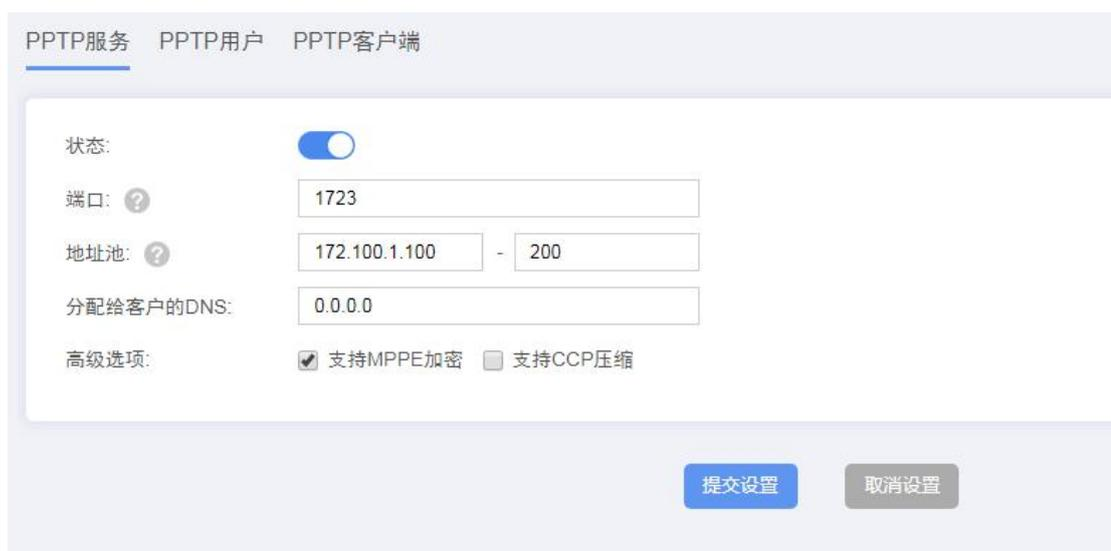
**状态：**默认为关闭状态，开启状态后可配置 PPTP 相关参数；
