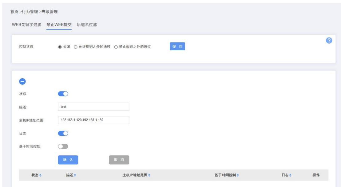
**控制状态：**分别有关闭、允许规则之外的通过、禁止规则之外的通过三种状态
